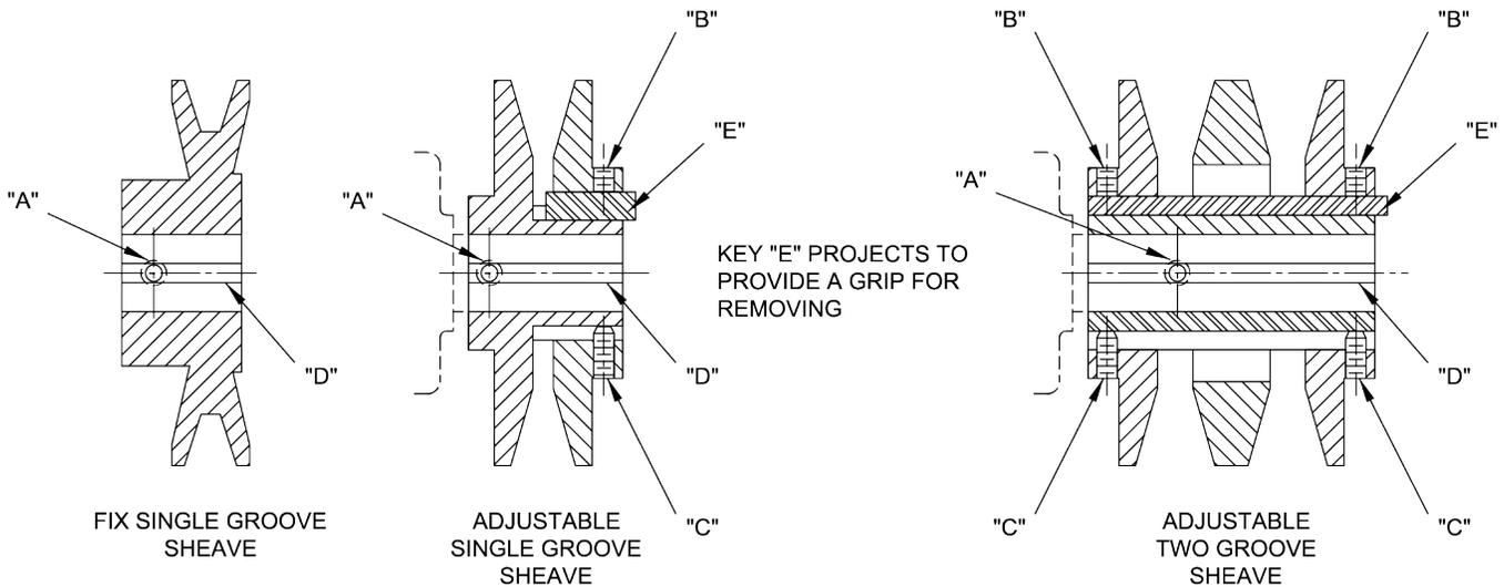
DO NOT OPERATE SHEAVE WITH FLANGE PROJECTING BEYOND THE HUB END.
